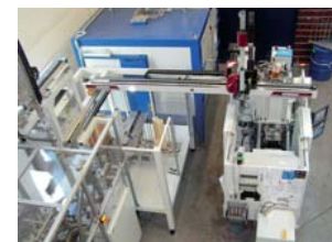
Spritzgießmaschine - Magazinierung und Ofen
