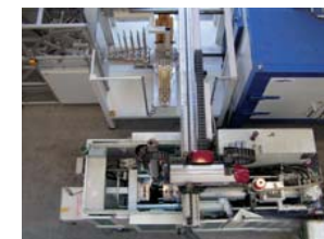
Übergabe der Spritzgießteile an das Magazin
